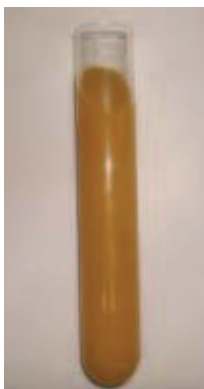
Figura 3 – Amostra do gel cremoso após período em estufa à 40 °C e centrifugação a 3000 rpm durante 60 minutos.
