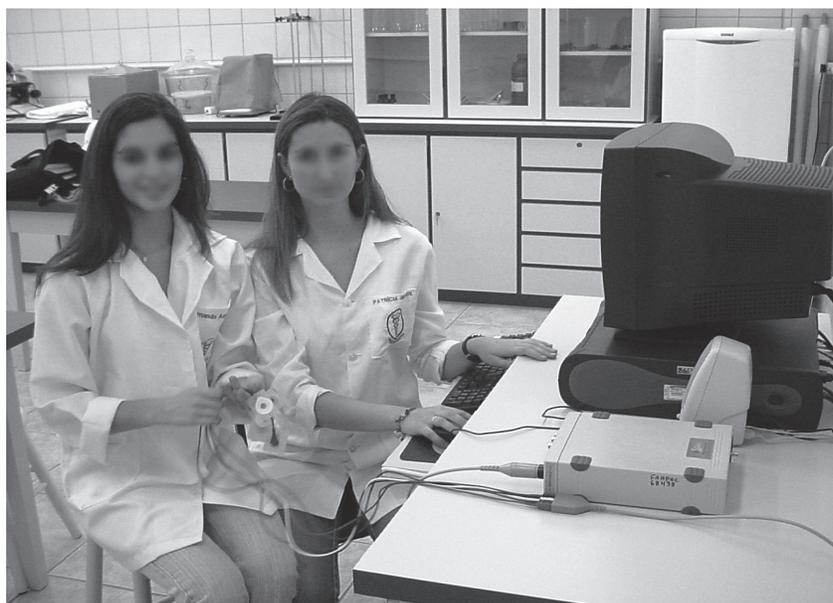
**Figura 4.** Eletromiografo acoplado ao computador.
