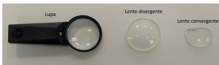
Figura 3 - Lentes utilizadas no experimento: lupa e lentes de óculos divergente e convergente, respectivamente.
