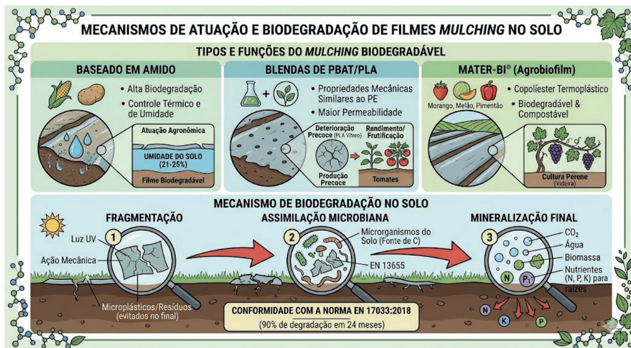
Figura 2 - Principais filmes mulching e seus mecanismos de atuação no solo.
