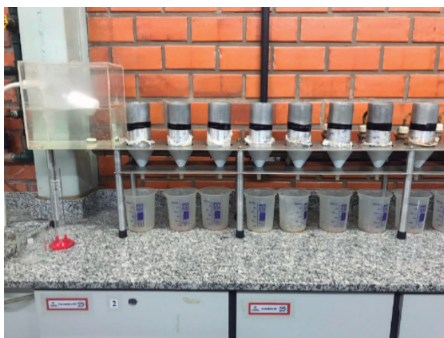
Figura 2 - Amostras no Permeômetro de Carga Constante.
