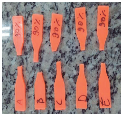
Figura 5 - Corpos de prova do tipo V pós-ensaio de tração.
