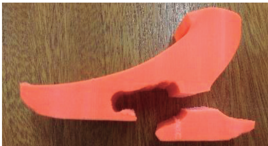
Figura 19 - Prótese rompida após ensaio de compressão.
