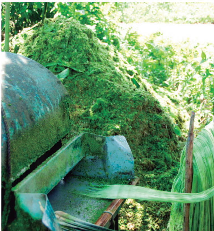
Figura 1 - Parte do processo de extração das fibras das folhas do abacaxi para a fabricação do Piñatex TM .
