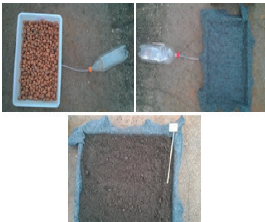
Figura 3 - Construção do modelo 3, colocação da argila, manta Bibim e solo.
