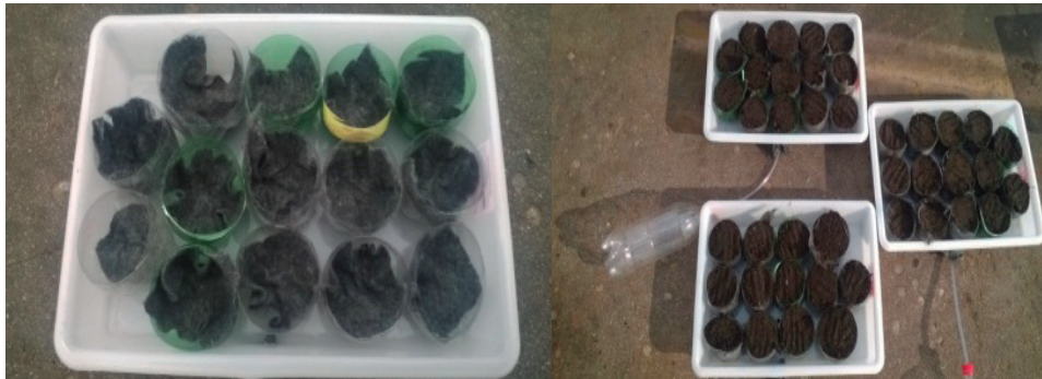
Figura 1 - Construção do modelo 1: posicionamento das garrafas, colocação da manta Bidim e solo nos recipientes.
