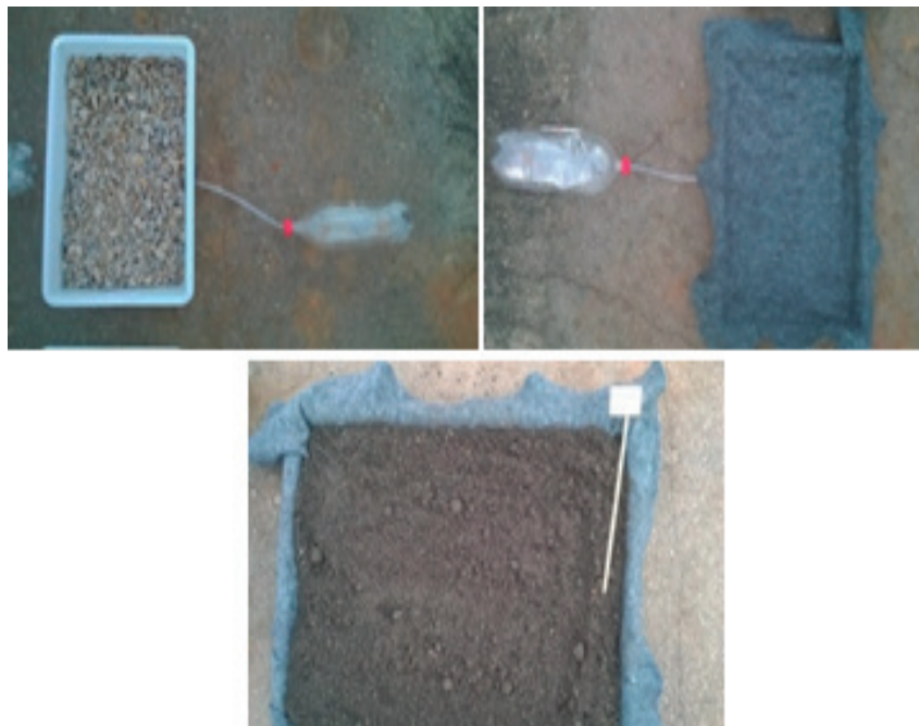
Figura 2 - Construção do modelo 2: colocação da brita, manta e solo.
