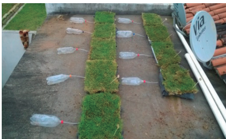
Figura 5 - Última etapa na construção dos modelos, colocação das leivas de gramínea e posicionamento na laje.
