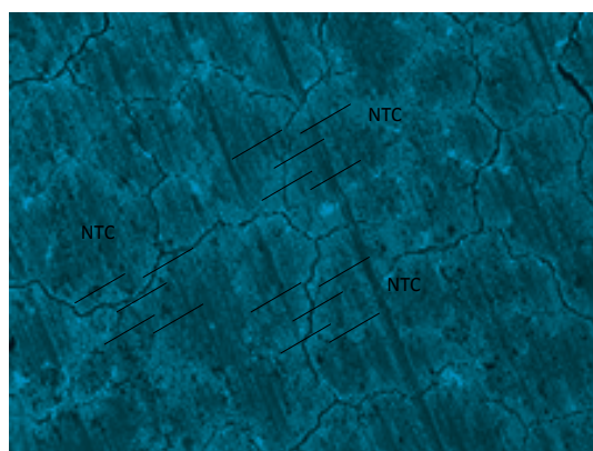
Figura 7 - Esquema: NTC disperso na matriz cimentícia em processo de início de fissuração.
