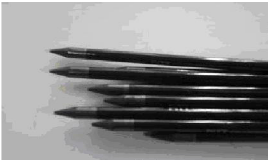
Figura 2 - Imagem fotográfica das barras de grafite utilizadas como eletrodos (Faber Castell, 6B), na produção de microsferas e nanosferas de carbono por arco elétrico em meio aquoso.
