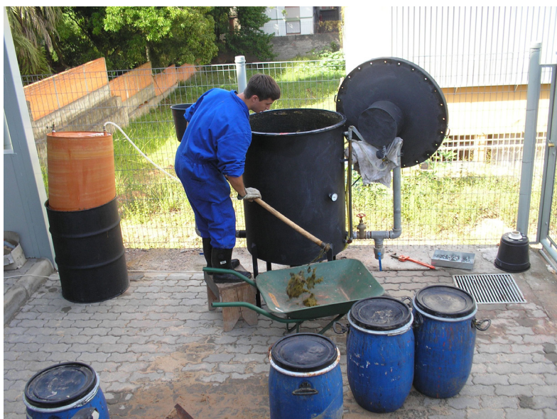
Figura 5 - Verificação das condições internas do biodigestor.
