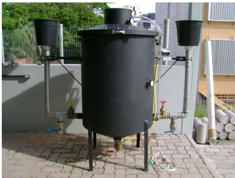
Figura 1 - Biodigestor construído no Laboratório de Engenharia Ambiental do Centro Universitário Franciscano - UNIFRA. Santa Maria, RS, 2009.
