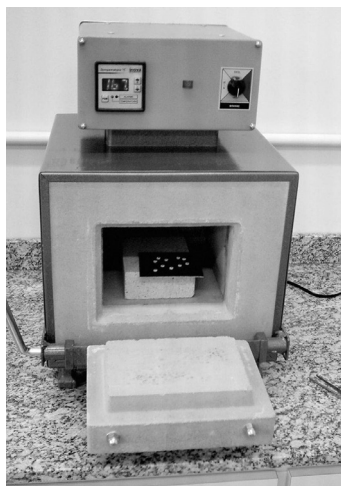
Figura 1 - Forno utilizado para tratamento térmico das pastilhas de LiF.
