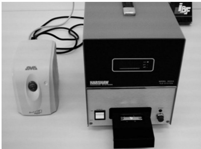
Figura 4 - Sistema de leitura termoluminescente.
