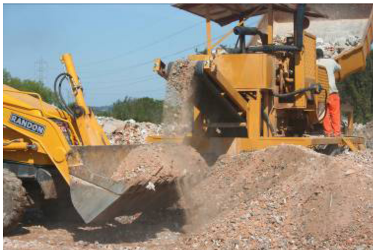
Figura 2 - Mostra de resíduos classe A sendo triturados no pátio da empresa GR2 para posterior comercialização como material reciclado.
