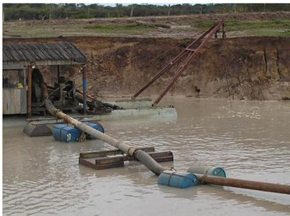
**Figura 3** - Processo de extração de areia por draga submersa.
