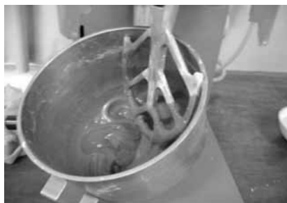
Figura 3 – Misturador de argamassa.
