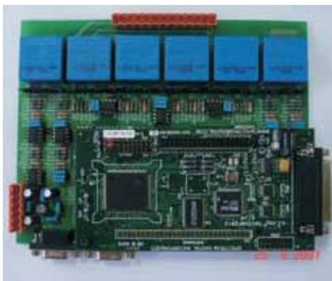
Figura 2 – Unidade Remota de Aquisição de Dados (URAD): sensores de tensão (LV20) e corrente (LA20); conector barramento de dados; conector da alimentação; saída RS 232 e 485; DSP TMS320F2812; transceiver TRW 2.4G®.
