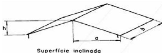
**Figura 2.** Indicação para cálculo da área de contribuição, NBR 10844 (ABNT, 1989).
