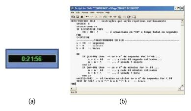
**Figura 1 -** (a) Campo de texto e (b) seu *script*, componentes responsáveis pelo funcionamento do contador de tempo.
