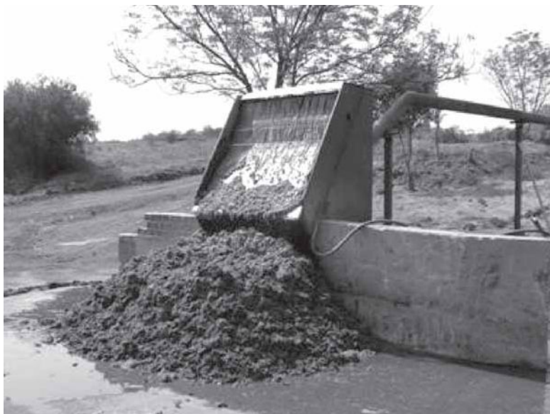
Figura 2. Peneira Estática realizando a remoção dos sólidos em 13/9/2006.
