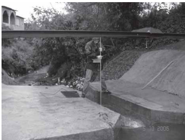
Figura 7. Determinação da velocidade da água na calha Parshall com vazão média.
