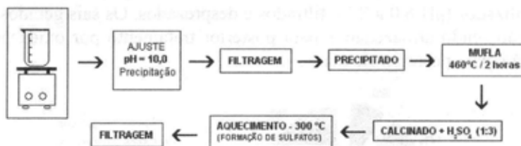
Figura 5. Procedimento para tratamento de resíduo de alumínio, gerado na disciplina de química analítica quantitativa.
