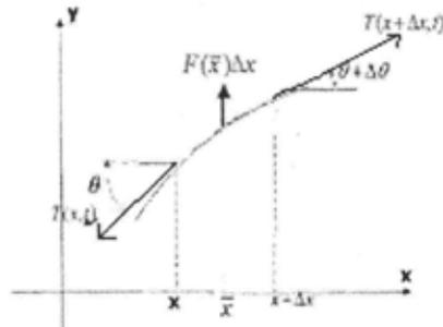
Figura 2 - Elemento deslocado da Corda Elástica.
