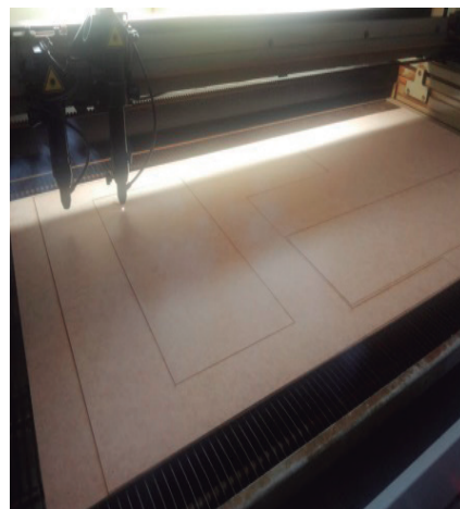
Figura 8 - Cortadora a Lazer executando o corte no material MDF.
