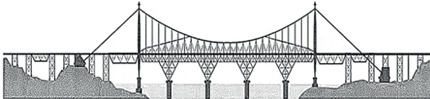
Figura 1. Ponte Hercílio Luz, em Florianópolis, com 821 metros de extensão e 15,92 metros de largura de vão central.
